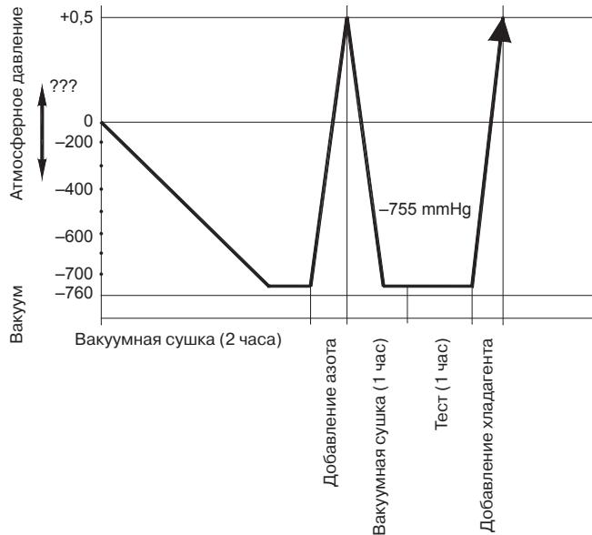
После первого вакуумирования добавьте в контур осушенный азот при давлении до 25 кг/см<sup>2</sup> на 30 минут. Удалите азот и снова отвакуумируйте систему. После проверки на утечку добавьте хладагент.
