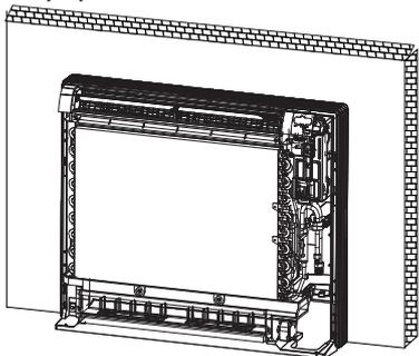
При монтаже на стене внутренний блок требуется дополнительно закрепить 4 винтами.
