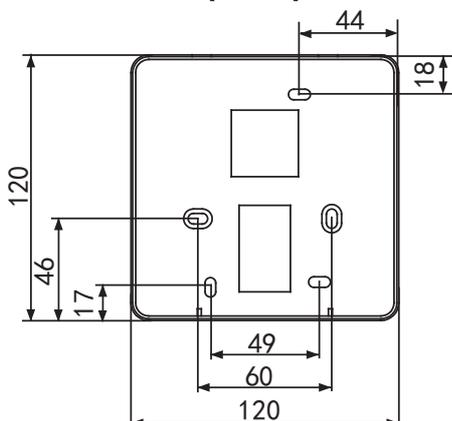
Перед установкой пульта ДУ выполните скрытую проводку кабеля в точку, соответствующую середине верхней кромки пульта ДУ.
