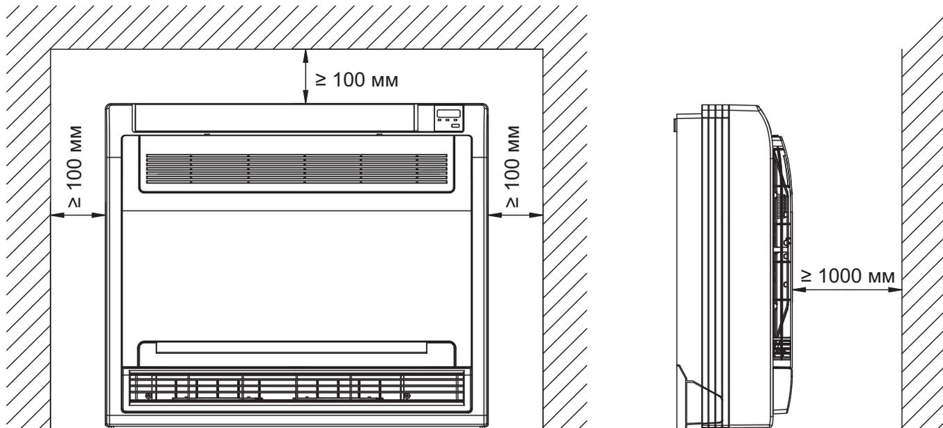
Внутренний блок подвешивается на креплениях к стене.
