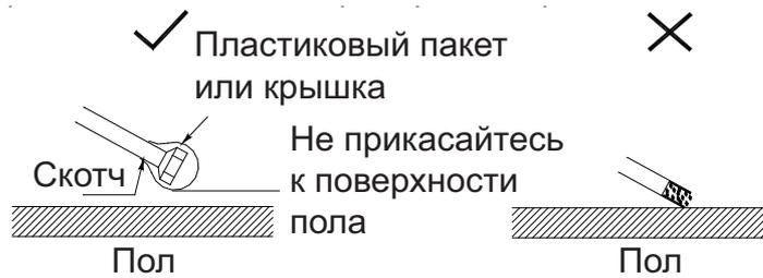
4) Отрезайте трубу и удаляйте заусеницы направив обрабатываемый конец вниз.
