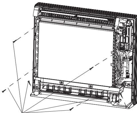
После окончания всех подключений установите переднюю часть корпуса на место.
