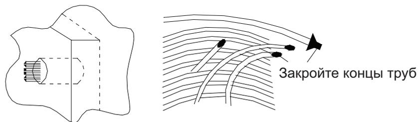
Если открытый конец трубопровода находится на улице, то велика вероятность попадания внутрь трубы пыли, грязи, или капель дождя, особенно если труба расположена вертикально.
